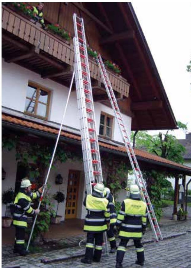
Aufbau der Schiebeleiter durch zwei Trupps
