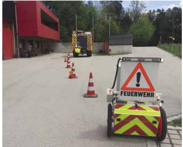
Beispielhafte Verkehrsabsicherung mit Leitkegel, Euroblitzer und Haspel
